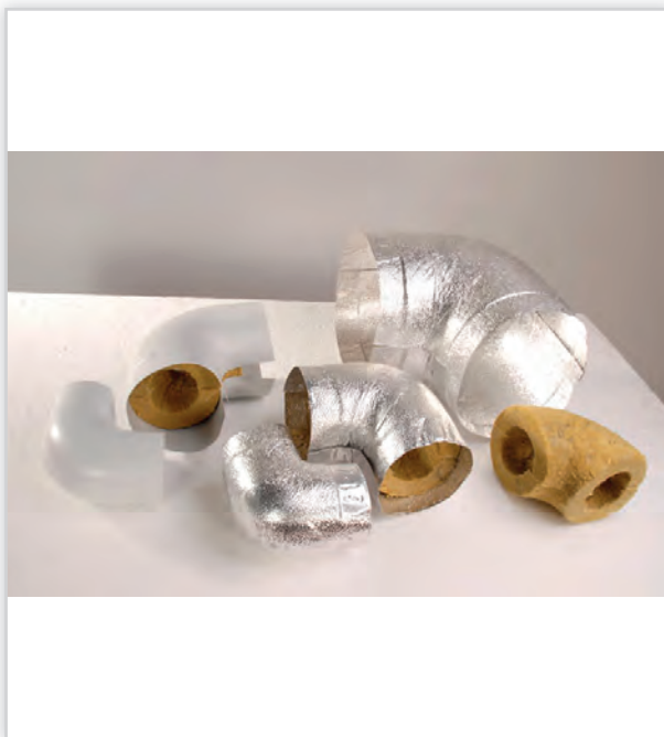
KORFF Isolmatic, Kolana z wełny mineralnej . Rodzaj materiału izolacyjnego: wełna mineralna. Rodzaj płaszcza: folia aluminiowa wytłaczana z efektem rolowania. Sposób zamknięcia: nity Kocopak-Alu lub stalowe. Klasa palności płaszcza: niepalny. Współczynnik przewodności cieplnej przy t_m = 20^\circ\text{C} [W/(mK)]: 0,043. Gęstość [kg/m 3 ]: 80. Temperatura dopuszczalna [°C]: 250.
