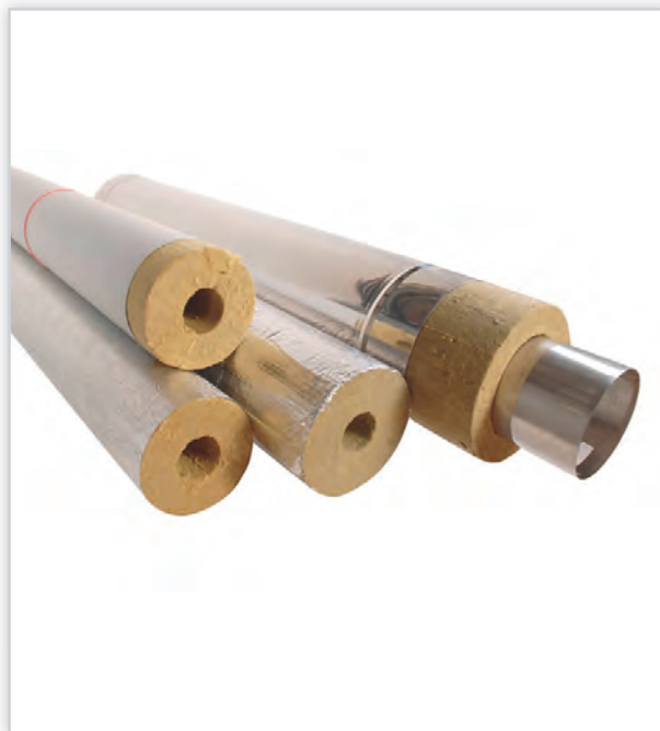
KORFF Isolmatic, Otuliny z wełny mineralnej . Rodzaj materiału izolacyjnego: wełna mineralna. Klasa palności materiału izolacyjnego: niepalny wg PN-93/B-02862. Współczynnik przewodności cieplnej przy t_m = 20^\circ\text{C} [W/(mK)]: 0,043. Gęstość [kg/m 3 ]: 80. Temperatura dopuszczalna [°C]: 250. Długość handlowa [mm]: 1000.
